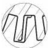
Fig. 3 das einfache und schnelle Herstellen säulenartiger Formen wird durch die Enden der Stegplatten begünstigt
